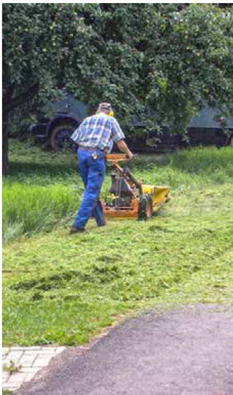
Bild 1: Der Hochgras-Allmäher® AS 28 2T von AS-Motor eignet sich sehr gut für Streuobstwiesen.
